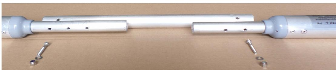
Quando i due semi elementi sono pronti, preparare la piastra centrale ed assemblare tutte la parti come da foto. La piastra di interfaccia mast-antenna può essere di forma tonda oppure rettangolare, fermo restando la sua funzione. Fate in modo che i due semidipoli rimangano distanti tra loro di almeno 1cm.
