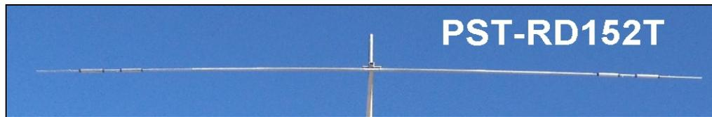
Dopo aver completato le operazioni di messa a punto, controllare il serraggio di tutti i dadi. Qualora il dipolo venisse montato al disopra di una yagi HF, è preferibile che esso sia installato parallelo al boom della yagi e ad una distanza verticale di almeno 2m. Se installato da solo è preferibile che sia ad almeno 5m dal solaio/tetto/suolo.
